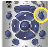
b. Presione y suelte los botones CHANNEL UP/DOWN o PAGE UP/DOWN para resaltar el canal que desea ver.
